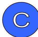
Los incendios que involucran equipo eléctrico energizado. Este tipo de incendio se puede controlar por un agente extintor no conductor. El procedimiento más seguro es siempre tratar de desconectar los circuitos de alto voltaje y tratarlo como un incendio clase A o B. Estos se simbolizan con un círculo azul y la letra “C” en el centro.
